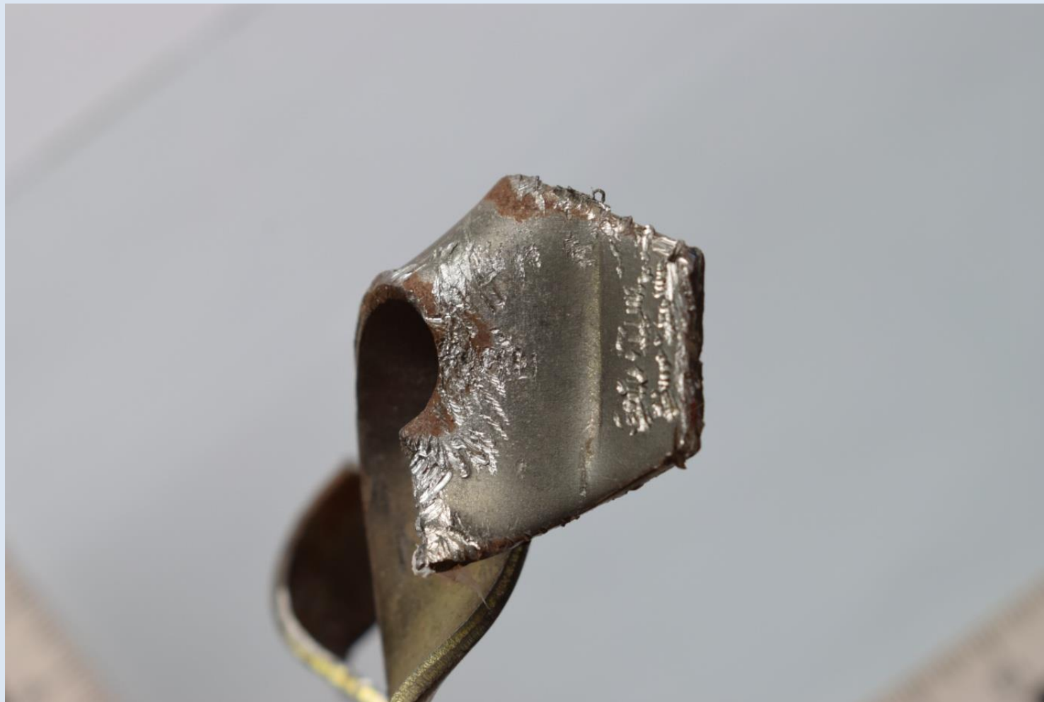
Fot. 22. Nieprawidłowo zabezpieczony do badań mechanoskopijnych fragment metalu z wnyków /M. Dąbrowski
