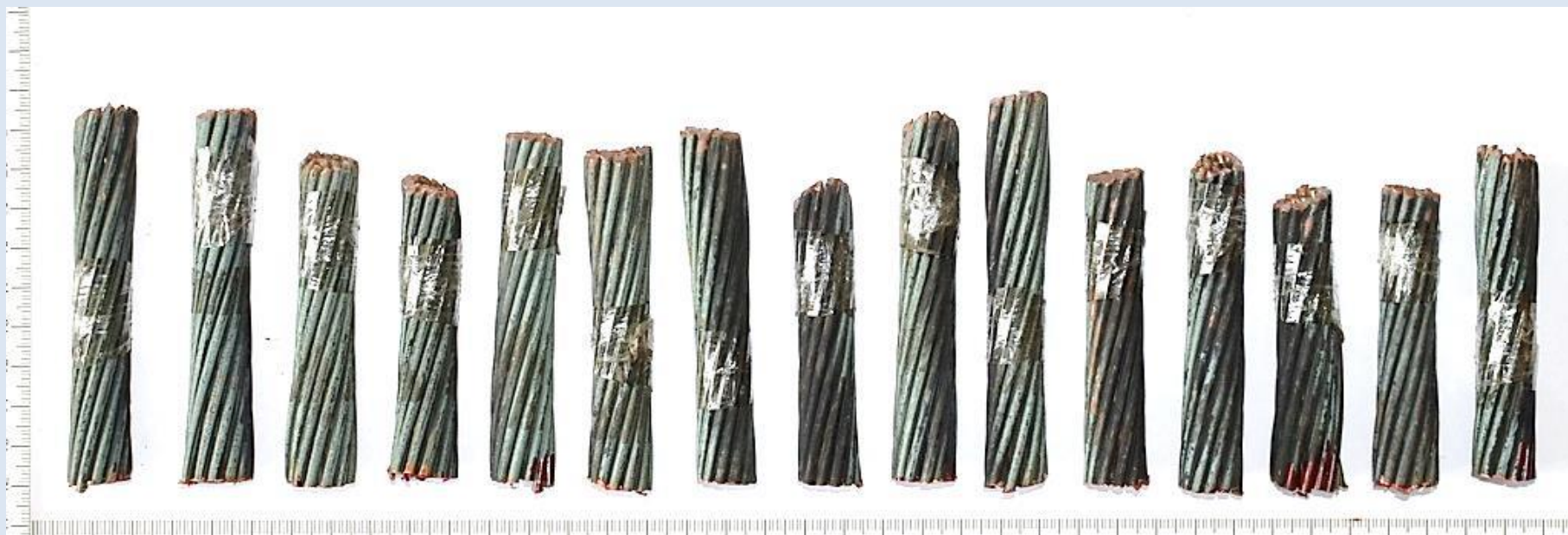
Fot. 21. Nieprawidłowo zabezpieczone do badań mechanoskopijnych fragmenty linek z wników /M. Dąbrowski.
